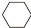
Predmet v pomanjšanem merilu M 1 : 2 – na risbi stranica predmeta meri 10 mm, v naravni velikosti pa 20 mm.
