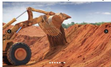
Boksit je surovina za izdelavo aluminija. Ležišča boksita so navadno šik pod površino, zato je odkopavanje preprosto. Ruda iz rudnika potuje v obrat za predelavo, kjer iz nje odstranijo nečistoče. Tako dobimo aluminijev oksid ali glinico. Glinica nato potuje v obrat za elektrolizo.
